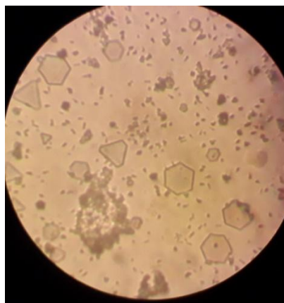
Рис. 2. Фотография микрокристаллов, синтезированных на поверхности инертной российской фотографической желатине в проходящем свете
