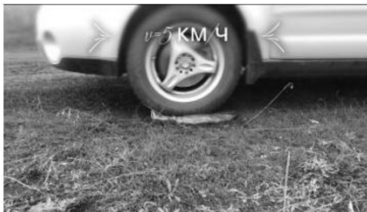
Рис. 4. Результат использования дилантантной жидкости на основе смеси картофельного крахмала и воды в качестве средства для ремонта дорог
