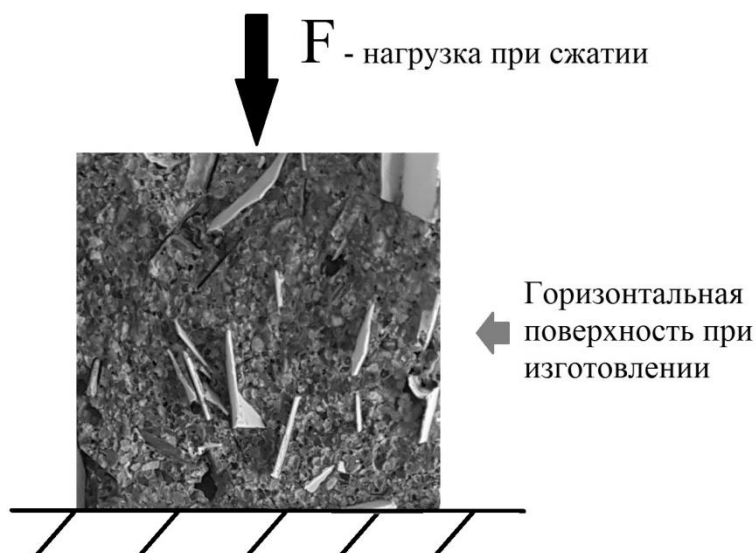
Рис. 8. Фотография сечения образца. Схема расположения отходов ПВХ в образце при испытании на сжатие
