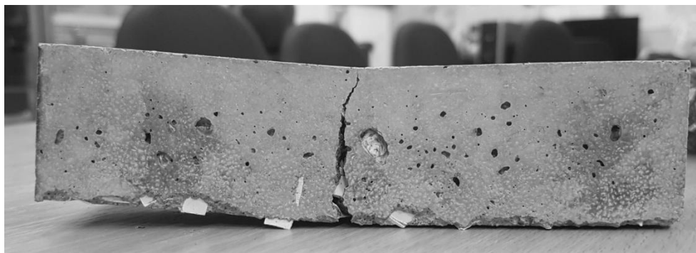
Рис. 5. Неполное разрушение образцов с добавлением ПВХ
