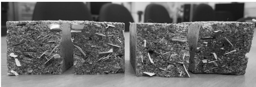
Рис. 6. Образцы после разрушения: слева две половинки – с отходами ПВХ, справа две половинки – с отходами ПВХ и добавлением ПВА
