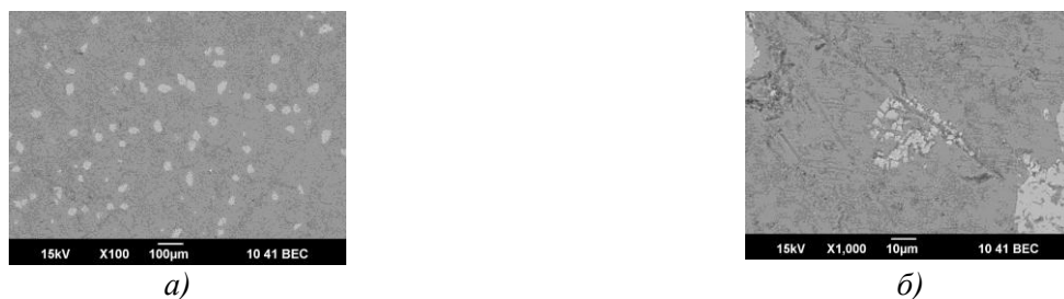
Рис. 5. СЭМ изображение поверхности шлифов образца Al +3 % V_2O_5 после отжига в воздушной среде в течение 1 часа при 1173 К
