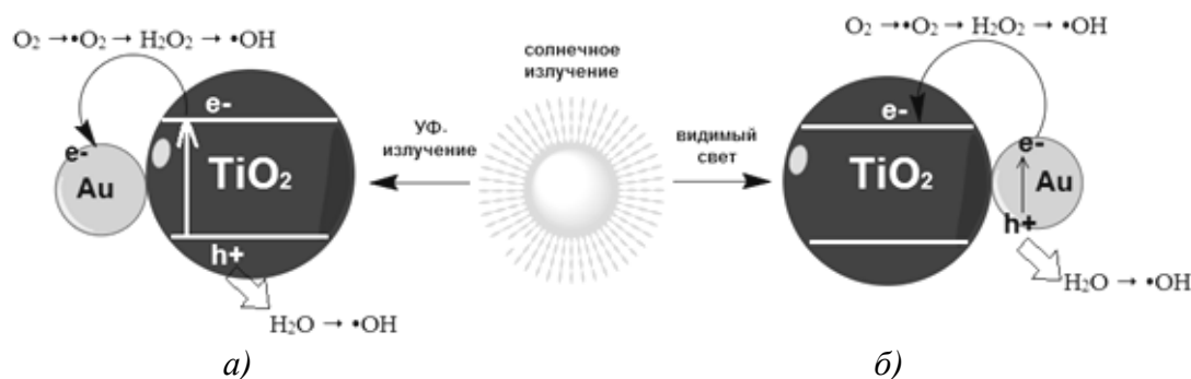
Рис. 2. Процессы, протекающие на поверхности \text{TiO}_2 , модифицированного НЧ золота, при воздействии УФ- (а) и видимым (б) светом
