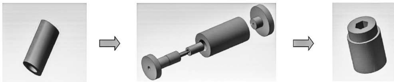
Рис. 6. 3D-модель процесса изготовления опорного изолятора
