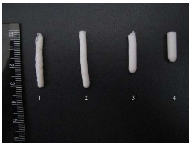
Рис. 2. Фото экструдатов фторопласта-4 при различных степенях обжатия: 1 – d_{\text{фил}}=2,2 мм; \lambda_{\text{экс}}=5,17 ; 2 – d_{\text{фил}}=2,5 мм; \lambda_{\text{экс}}=4 ; 3 – d_{\text{фил}}=3,8 мм; \lambda_{\text{экс}}=1,73 ; 4 – исходный образец. Температура испытаний T=295 К
