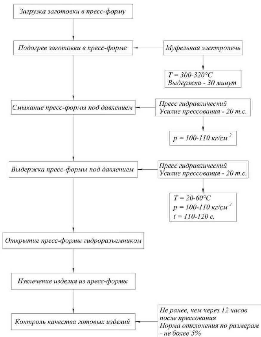
Рис. 5. Технологический регламент получения опорного изолятора объемной штамповкой
